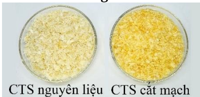
Hình 3.1. Hình dạng và màu sắc của CTS trước và sau khi cắt mạch bởi H_2O_2
